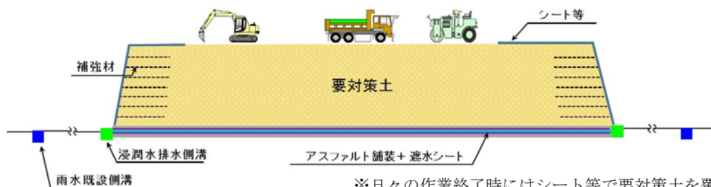
図 2-8(2) 塩島地区（南）発生土仮置き場における主な施工手順（発生土搬入、締固め）
