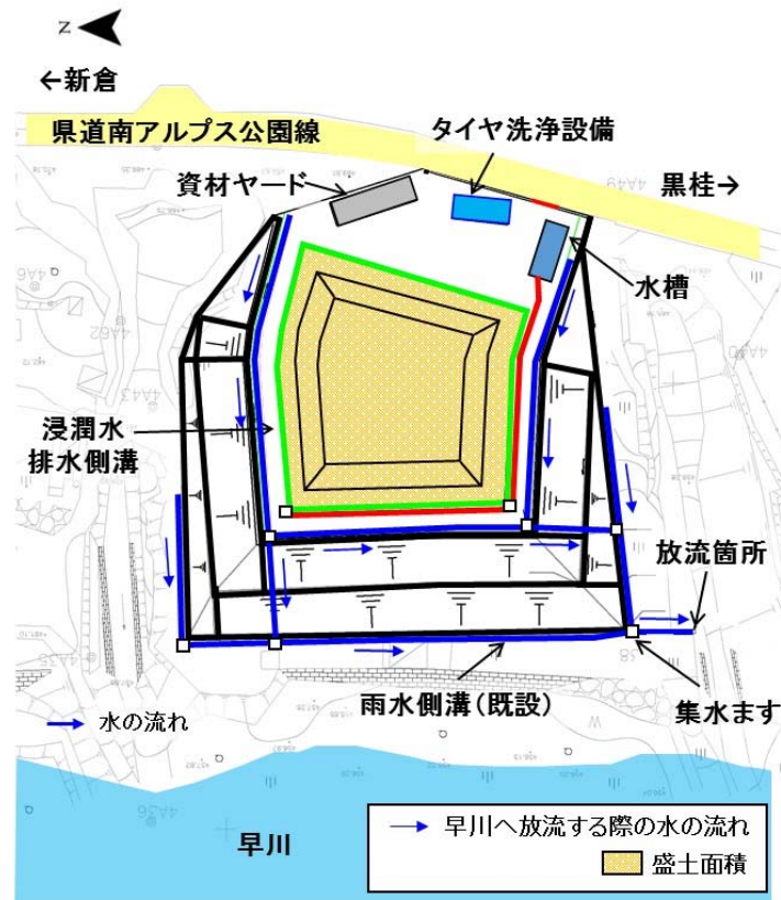
図 5-5 塩島地区（南）発生土仮置き場の雨水側溝
