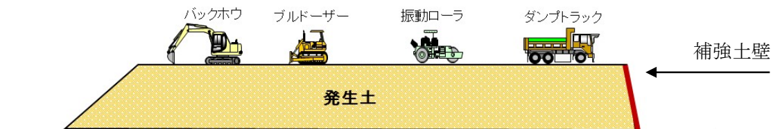
図2-4(1) 塩島地区（河川側）発生土仮置き場における主な施工手順（発生土搬入、締固め）
