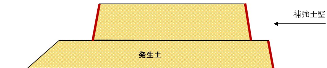
図2-4(2) 塩島地区（河川側）発生土仮置き場における主な施工手順（仮置き）
