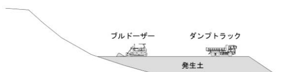
図2-3 発生土置き場における主な施工手順
