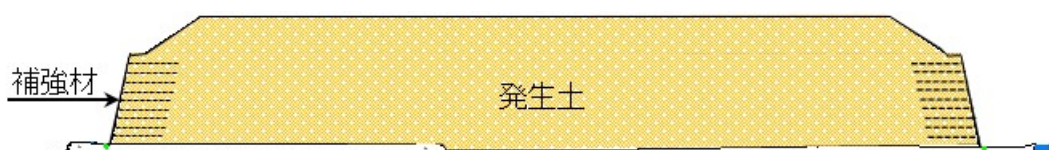
図2-4 (2) 中洲地区発生土仮置き場における主な施工手順（仮置き）
