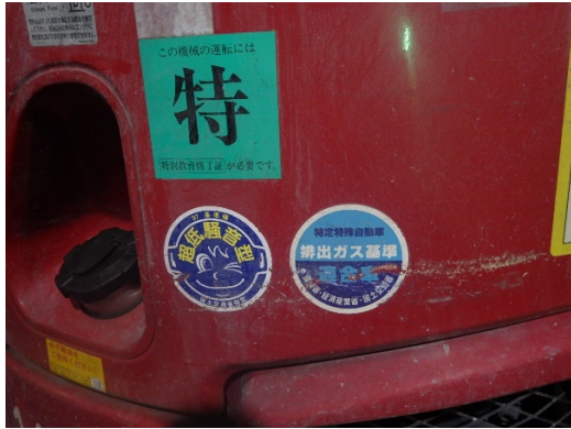
写真4-1-2-1 排出ガス対策型、低騒音型 建設機械の採用
