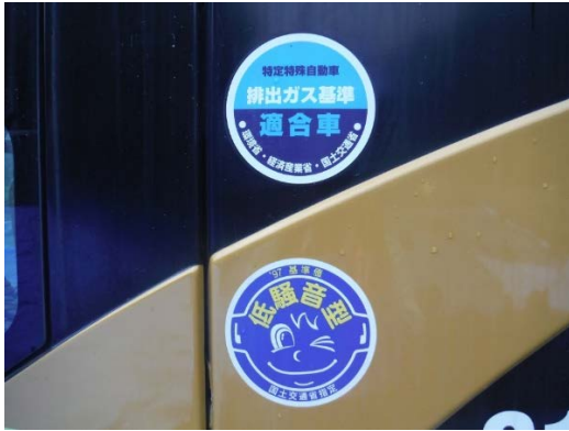
写真4-1-4-1 排出ガス対策型、低騒音型建設機械の採用
