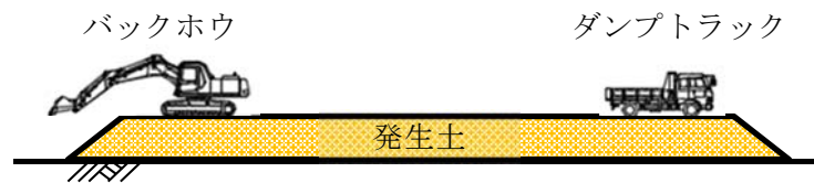
図2-4 (1) 奈良田地区発生土仮置き場における主な施工手順（発生土搬入、締固め）
