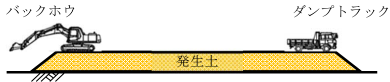
図2-4 (3) 奈良田地区発生土仮置き場における主な施工手順（発生土搬出）
