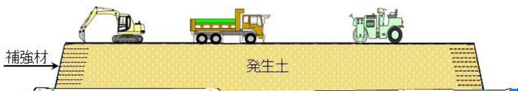
図2-4(1) 中洲地区発生土仮置き場における主な施工手順（発生土搬入、締固め）
