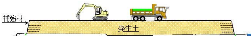
図2-4(3) 中洲地区発生土仮置き場における主な施工手順（発生土搬出）
