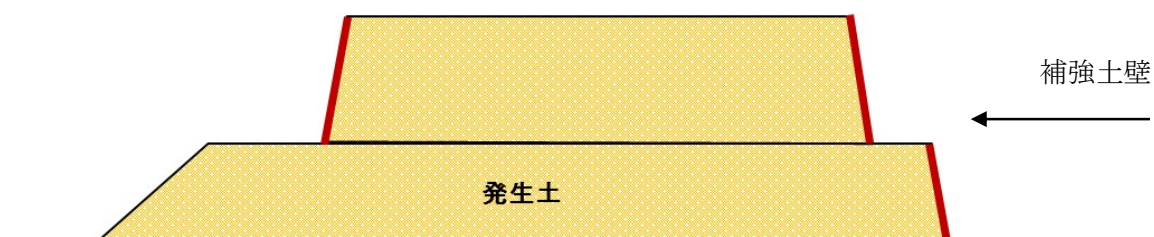
図2-4 (2) 塩島地区（河川側）発生土仮置き場における主な施工手順（仮置き）
