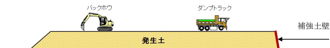
図2-4 (3) 塩島地区（河川側）発生土仮置き場における主な施工手順（発生土搬出）
