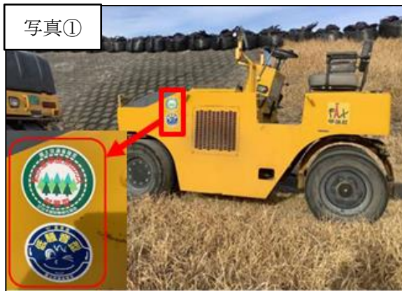
写真① 低騒音・排出ガス対策型建設機械の使用
