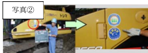
低騒音・低振動型建設機械の採用
