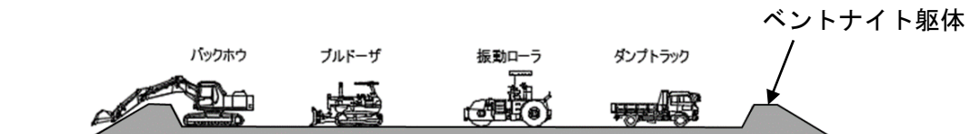
図 2-5(1) 雨畑地区発生土仮置き場における主な施工手順（ベントナイト躯体設置）
