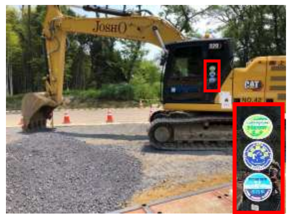
写真-6 低騒音型建設機械の採用（地点 01）
