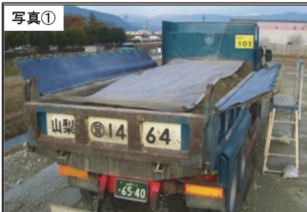
荷台への防じんシートの敷設
