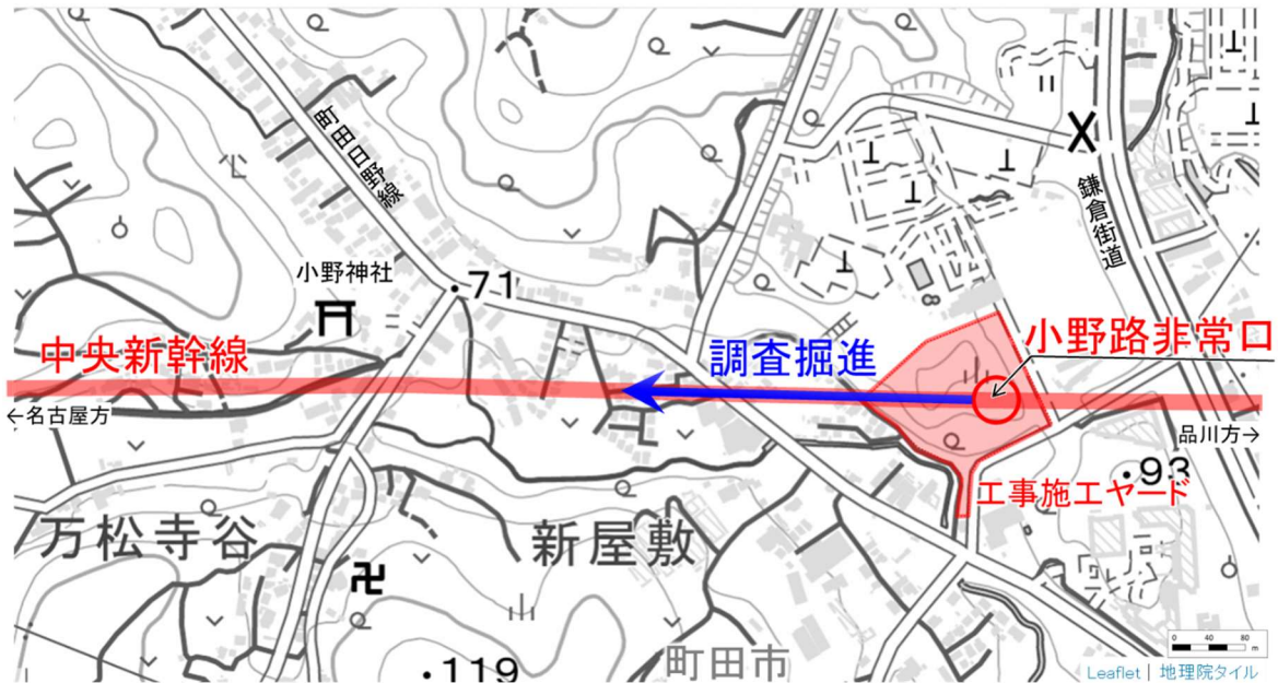
図 2-9 調査掘進の範囲（平面図）
