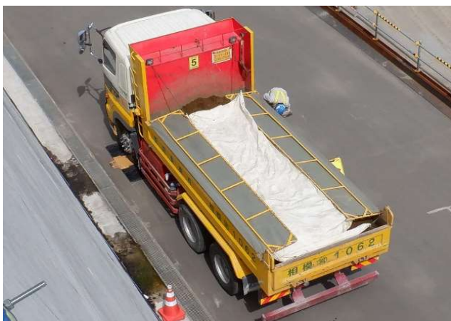
写真①：荷台への防じんシートの設置
