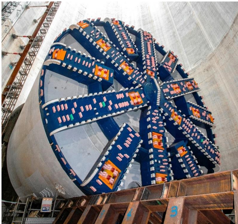
図 2-7 北品川非常口から等々力非常口までのトンネル掘進に使用するシールド機
