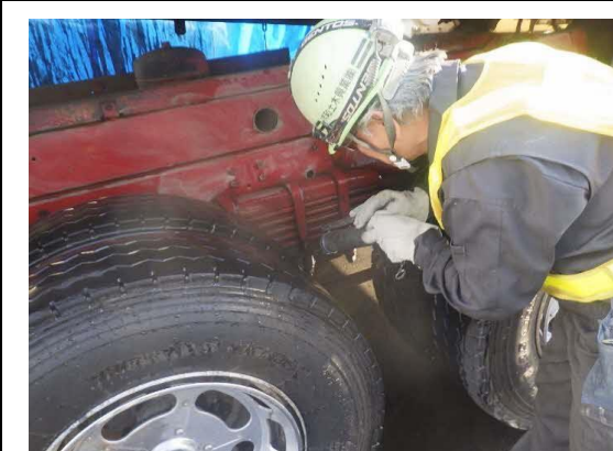
写真4-1-3-11 資材及び機械の運搬に用いる車両の点検及び整備による性能維持
