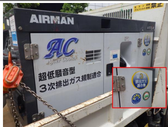
写真4-1-1-2 排出ガス対策型建設機械の採用
