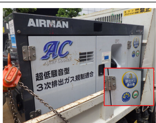
写真4-1-1-2 排出ガス対策型建設機械の採用
