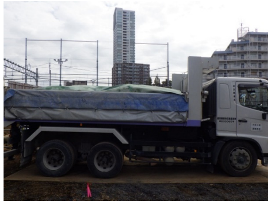
写真4-1-2-13 荷台への防じんシート敷設及び散水
