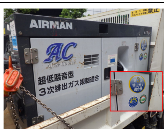
写真4-1-1-2 排出ガス対策型建設機械の採用
