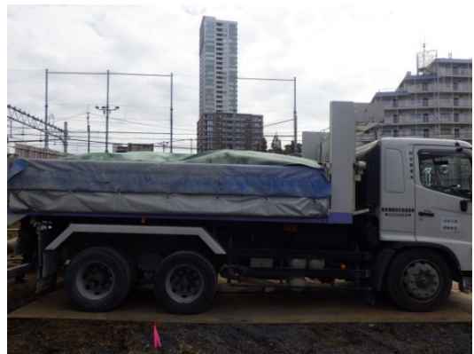
写真4-1-2-10 荷台への防じんシート敷設及び散水
