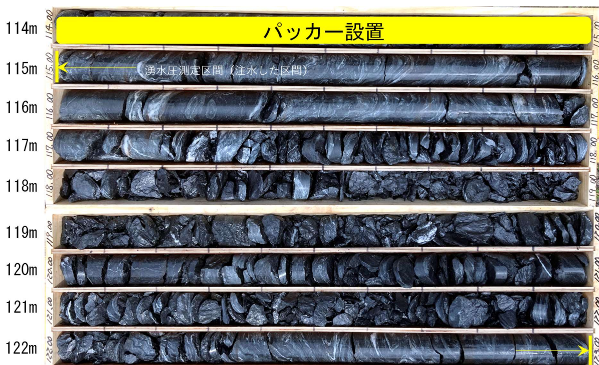
写真 6 孔内湧水圧測定 No. 3 (115.0m~123.0m) コア写真
