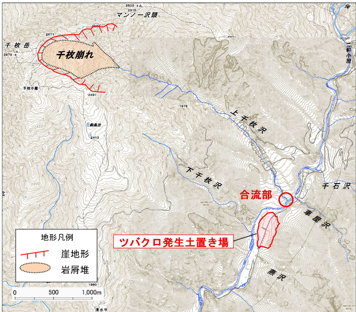
図 29 ツバクロ発生土置き場と崩壊地（千枚崩れ）との位置関係
