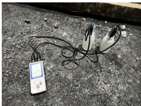
図 4 1 ボーリング湧水の水質測定
