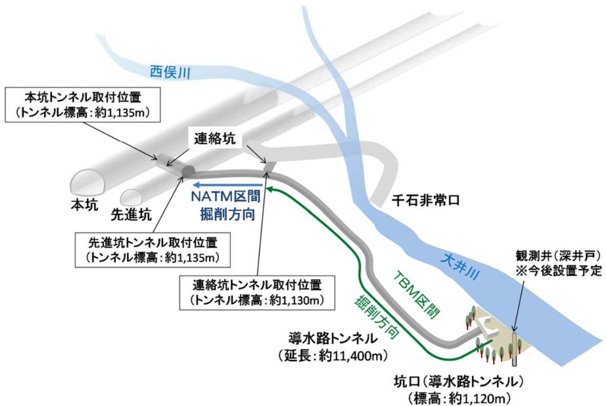
図 5.16 導水路トンネルの工事概要
