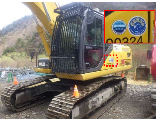
写真 5-1-2 排出ガス対策型、低騒音型建設機械の採用
