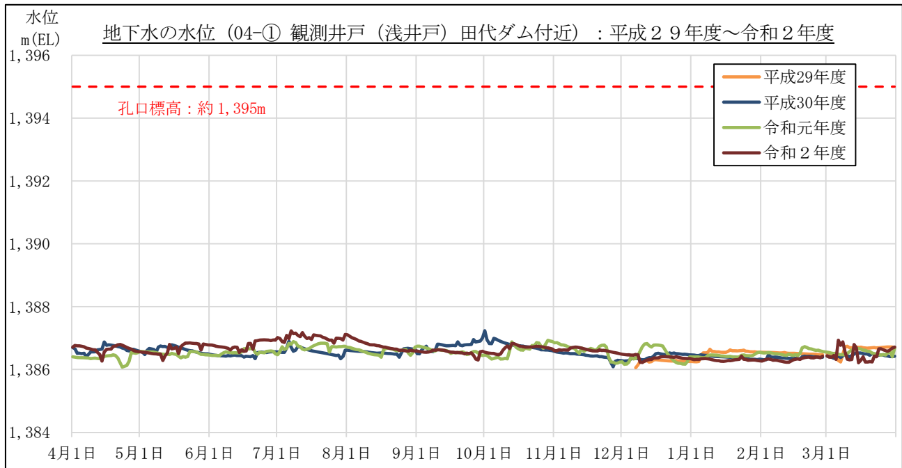
図 3-1-2(5) 地下水の水位計測結果 (常時計測) : 04-① 観測井戸 (浅井戸) 田代ダム付近
