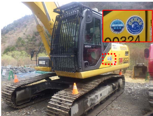
写真 5-1-2 排出ガス対策型、低騒音型建設機械の採用（一例）
