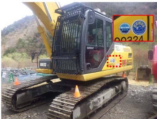
写真 4-1-2 排出ガス対策型、低騒音・低振動型建設機械の採用（一例）
