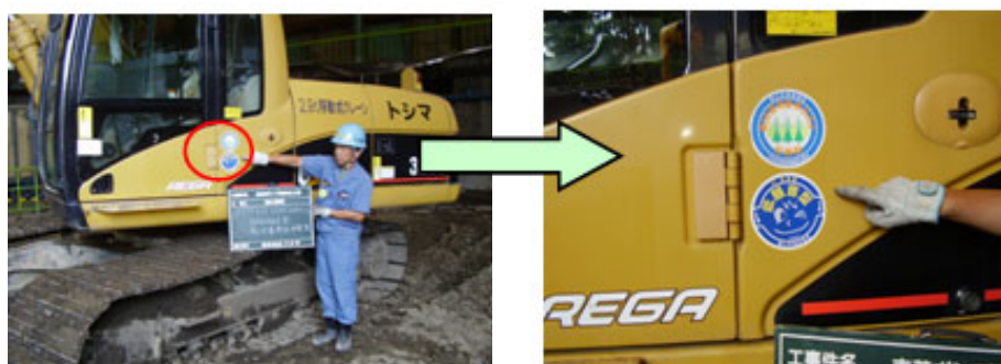
写真① 排出ガス対策型、低騒音・低振動型建設機械（写真は低騒音・排出ガス対策型）
