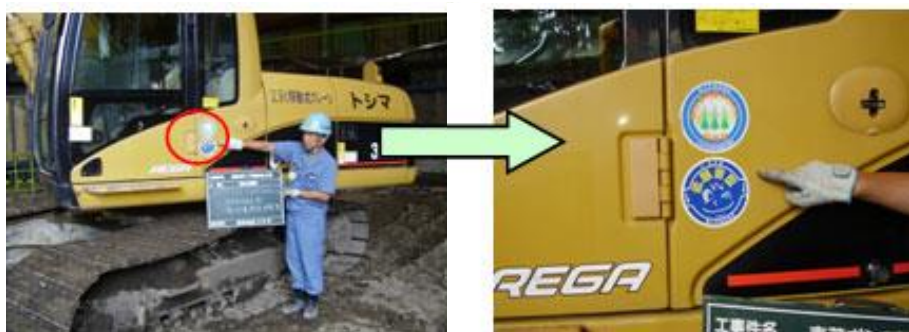
写真① 排出ガス対策型、低騒音・低振動型建設機械
