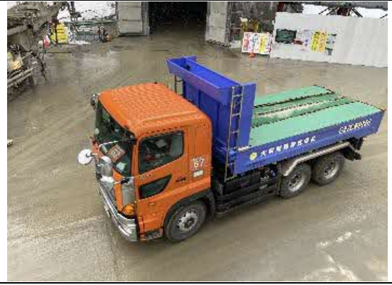
写真4-1-113 荷台への防塵シート敷設
