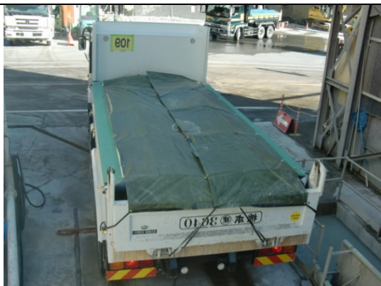
写真4-1-21 荷台への防じんシート敷設
