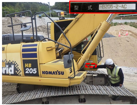
写真4-1-130 低炭素型建設機械の採用
