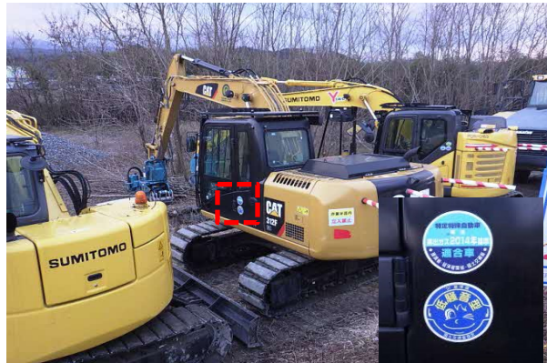
写真4-1-79 排出ガス対策型、低騒音型建設機械の採用
