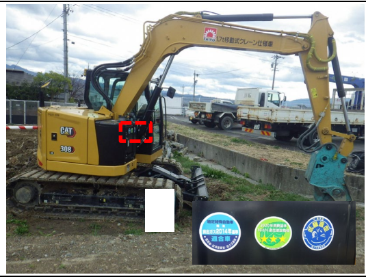
写真4-1-89 排出ガス対策型、低騒音型建設機械の採用
