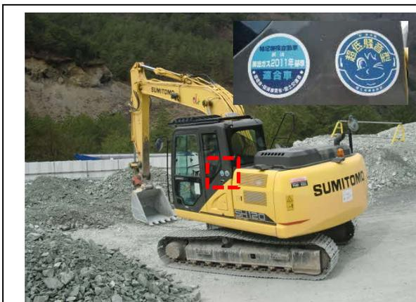
写真4-1-131 排出ガス対策型、低騒音型建設機械の採用
