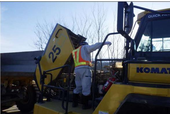
写真4-1-78 建設機械の点検状況
