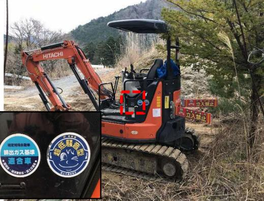
写真4-1-114 排出ガス対策型、低騒音型建設機械の採用
