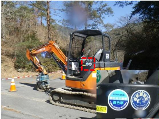
写真4-1-88 排出ガス対策型、低騒音型建設機械の採用
