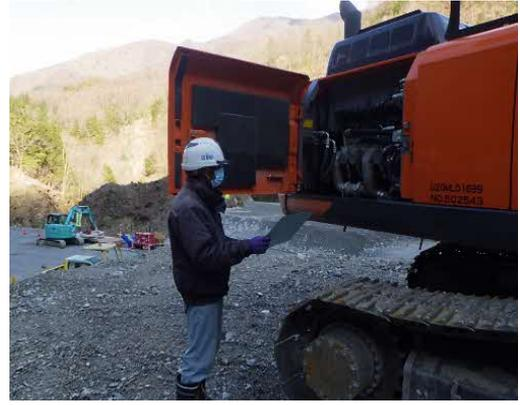
写真4-1-120 建設機械の点検及び整備による性能維持
