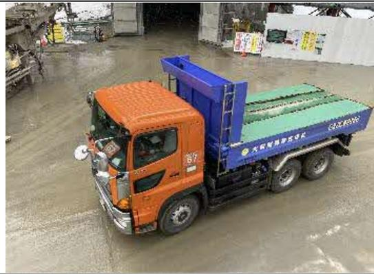
写真4-1-105 荷台への防塵シート敷設
