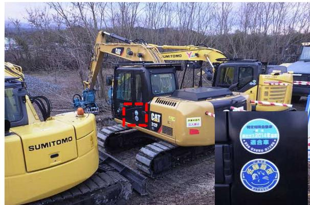
写真4-1-77 排出ガス対策型、低騒音型建設機械の採用
