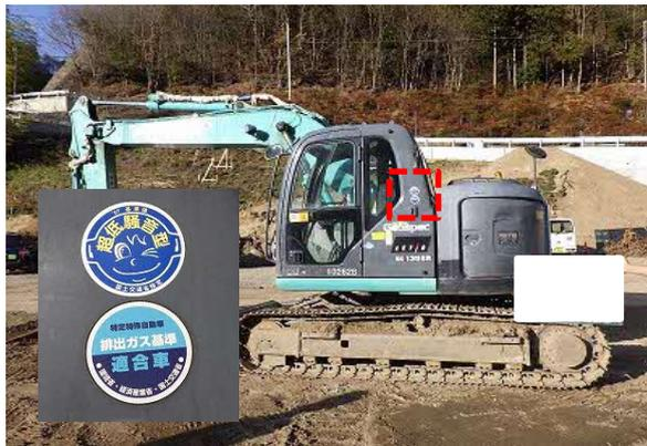
写真4-1-63 排出ガス対策型、低騒音型
