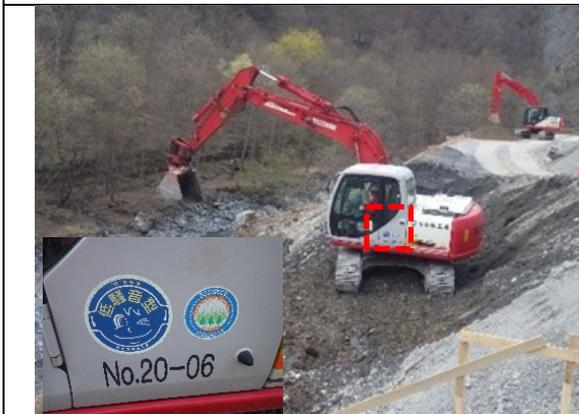
写真4-1-3 排出ガス対策型、低騒音型
