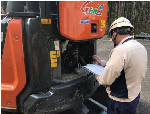
写真4-1-115 建設機械の点検状況
