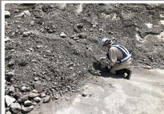
写真4-1-55 重金属等溶出試験試料採取の状況
