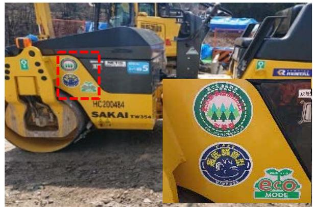
写真4-1-107 排出ガス対策型、低騒音型建設機械の採用
