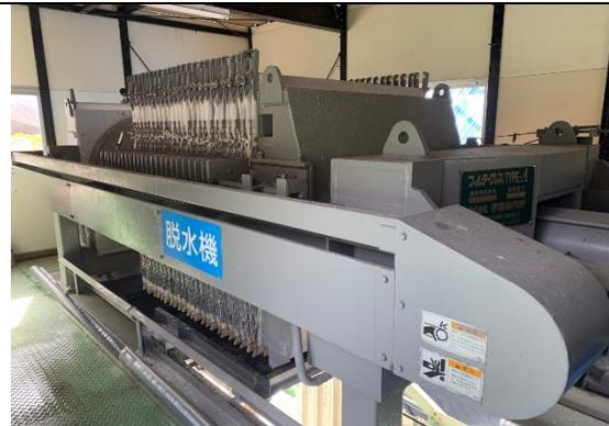
写真4-1-58 建設汚泥の処理状況
