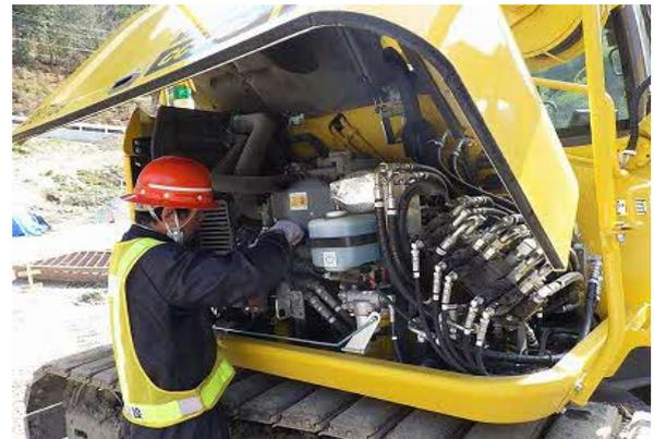
写真4-1-64 建設機械の点検及び整備に
