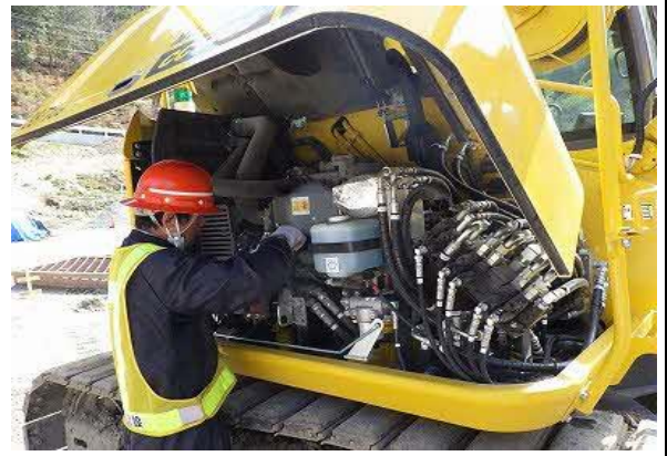
写真4-1-57 建設機械の点検及び整備による性能維持 (一例)
