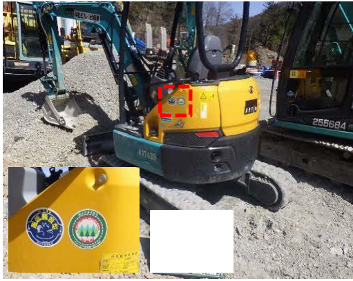
写真4-1-89 排出ガス対策型、低騒音型 建設機械の採用（一例）
