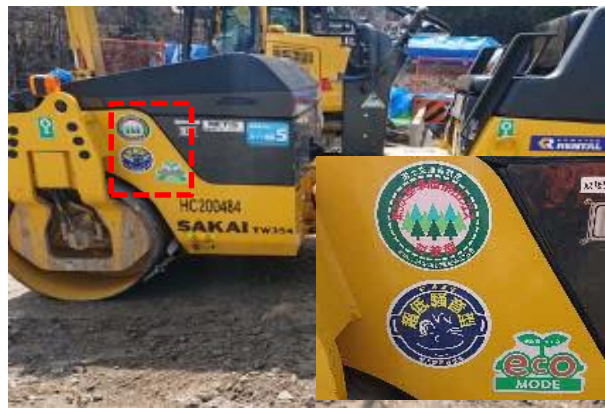
写真4-1-79 排出ガス対策型、低騒音型 建設機械の採用 (一例)
