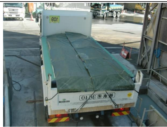
写真4-1-22 荷台への防じんシート敷設 (一例)
