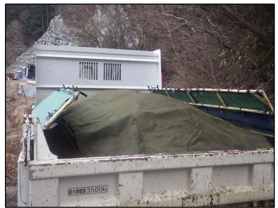
写真4-1-45 荷台への防塵シート敷設 (一例)
