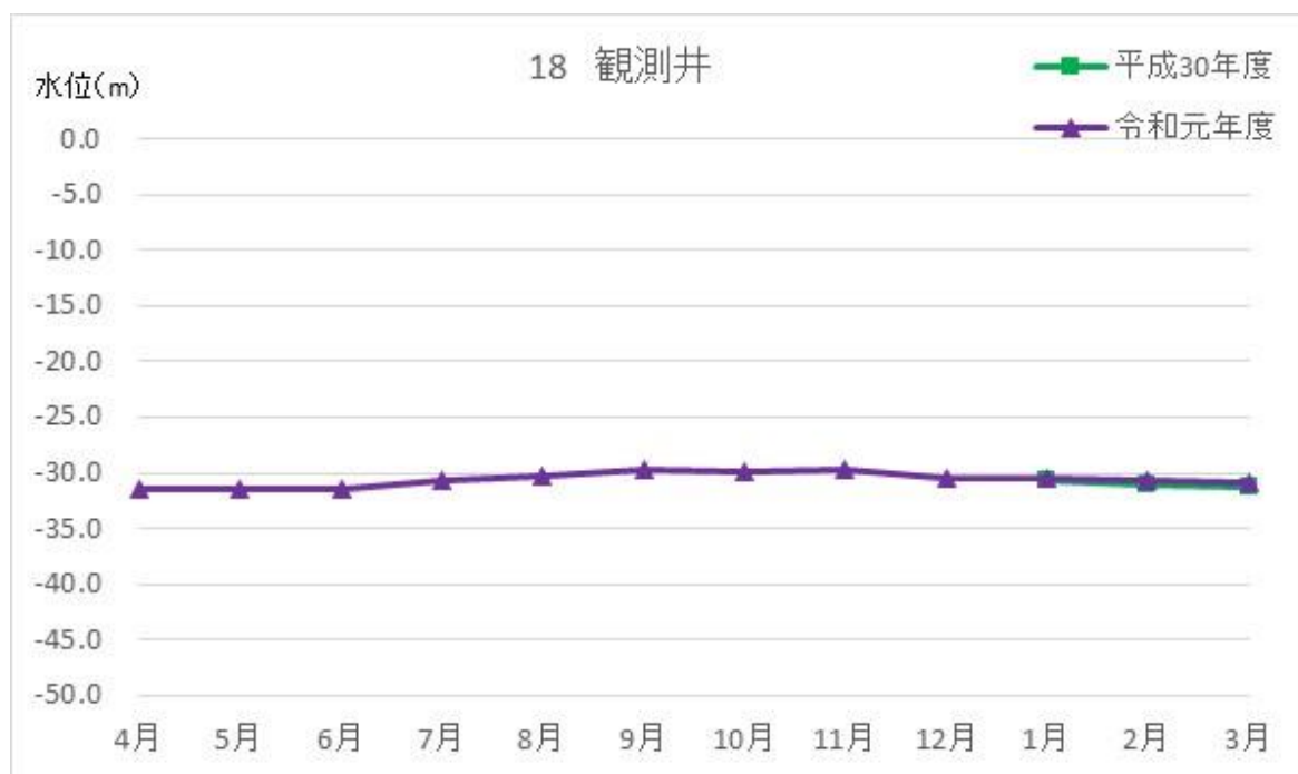
図 3-4-4-1(17) 地下水の水位及び湧水の水量の調査結果 (18 飯田市 観測井)
