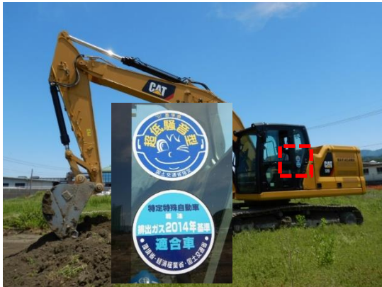
写真4-1-58 排出ガス対策型、低騒音型 建設機械の採用（一例）
