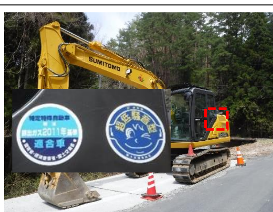
写真4-1-37 排出ガス対策型、低騒音型建設機械の採用 (一例)
