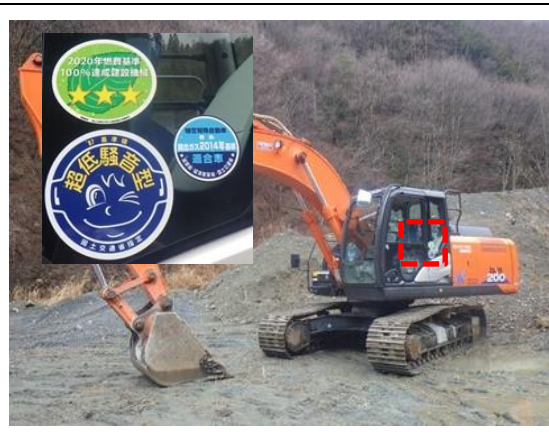
写真4-1-25 排出ガス対策型、低騒音型 建設機械の採用 (一例)
