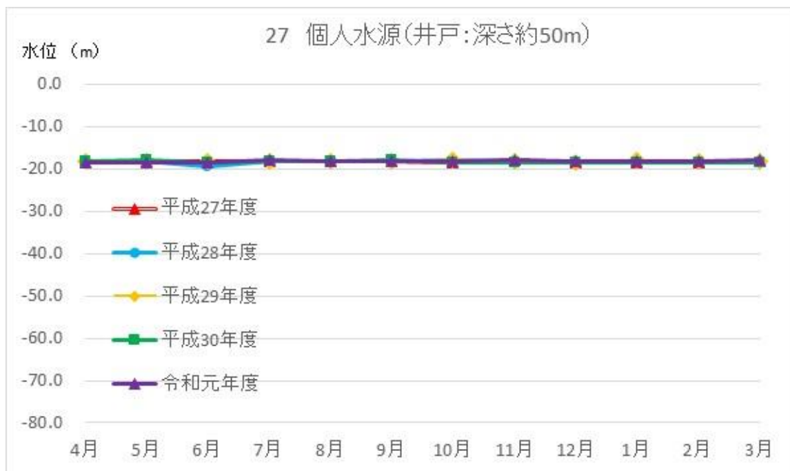
図 2-1-4-1(11) 地下水の水位及び湧水の水量の調査結果 (27 大鹿村 個人水源 (井戸：深さ約50m))
