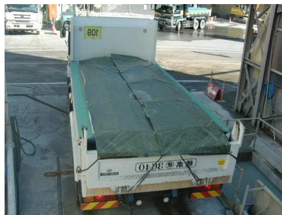
写真4-1-22 荷台への防塵シート敷設 (一例)
