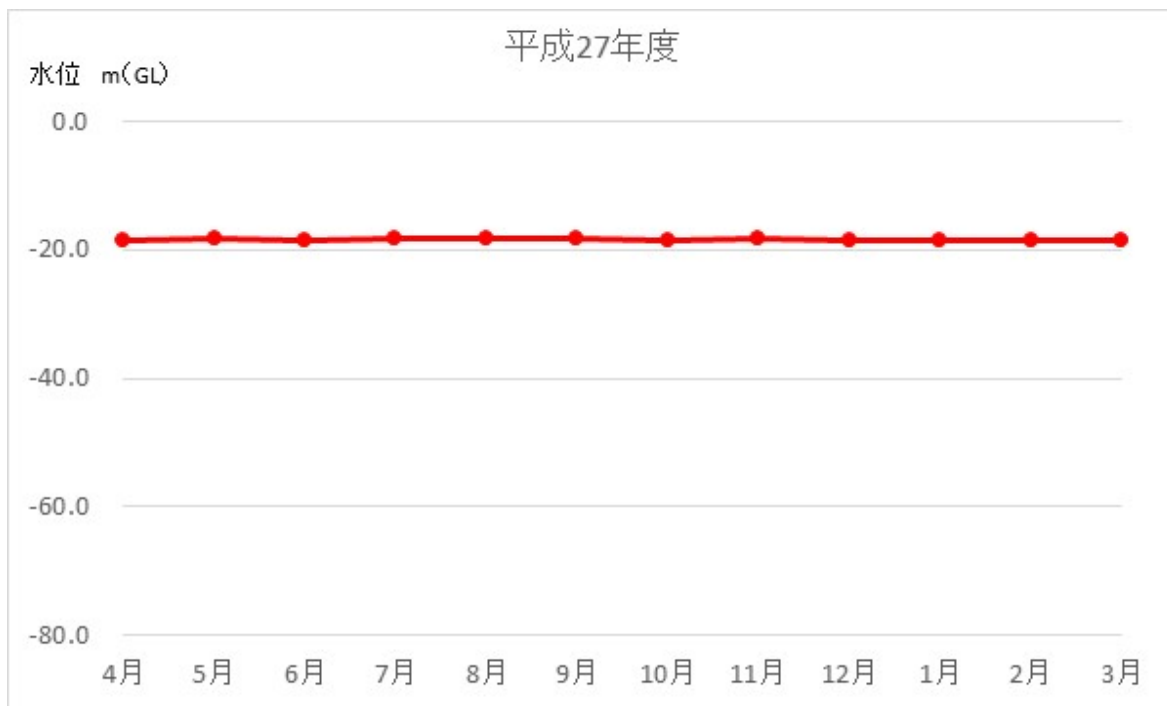
図 2-1-2(11) 地下水の水位及び湧水の水量の調査結果 (27 個人水源 (井戸：深さ約50m))
