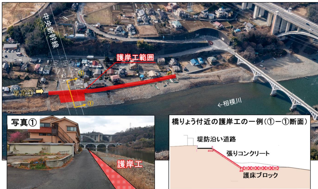
図 2-21 護岸工設置図
