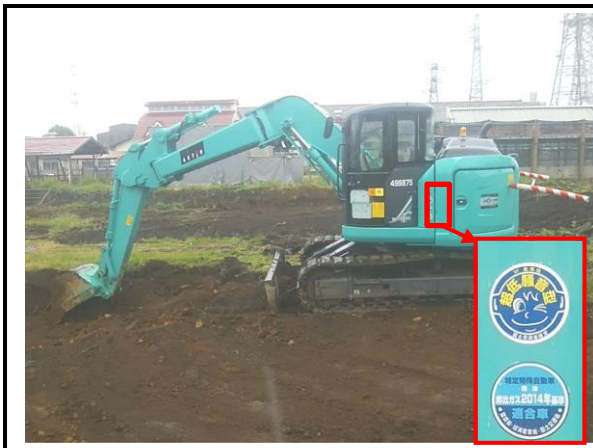
写真4-1-6-1 排出ガス対策型建設機械の採用 低騒音型建設機械の採用
