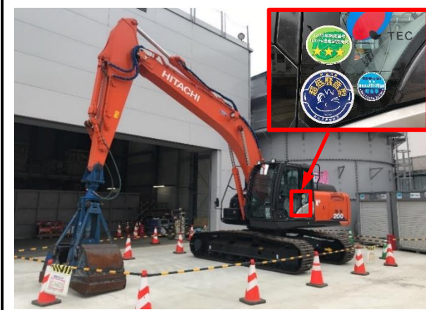
写真4-1-3-2 排出ガス対策型建設機械の採用 低騒音型建設機械の採用
