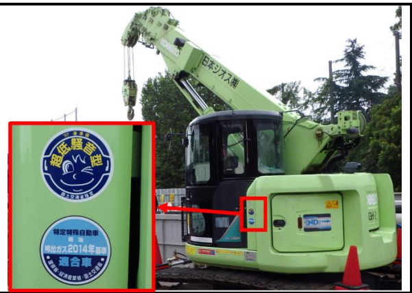
写真4-1-1-2 排出ガス対策型建設機械の採用 低騒音型建設機械の採用
