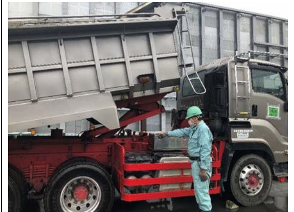
写真4-1-2-12 資材及び機械の運搬に用いる車両の点検及び 整備による性能維持、車両整備の徹底
