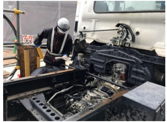
写真4-1-3-13 資材及び機械の運搬に用いる車両の点検及び整備による性能維持、車両整備の徹底
