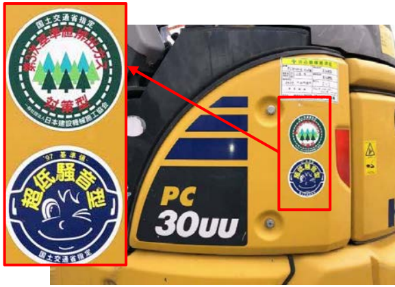
写真 4-1-9-1 排出ガス対策型建設機械の採用、 低騒音型建設機械の採用
