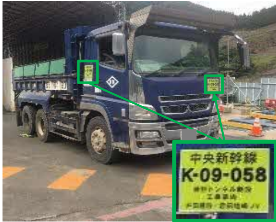
写真4-1-11-15 工事に使用する道路、 搬入時間及び法定制限速度の遵守 (車両標識明示による安全運転意識の向上)
