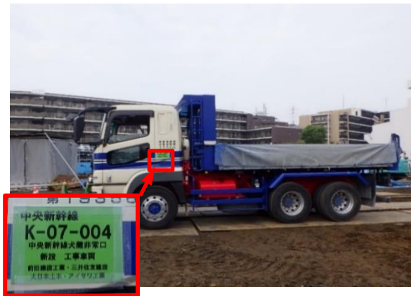
写真4-1-3-15 工事に使用する道路、 搬入時間の及び法定制限速度の遵守 (車両標識明示による安全運転意識の向上)
