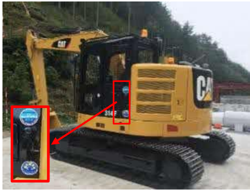
写真4-1-11-1 排出ガス対策型建設機械の採用 低騒音型建設機械の採用
