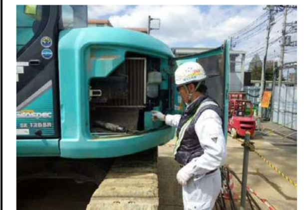
写真 4-1-7-3 建設機械の点検及び整備による性能維持
