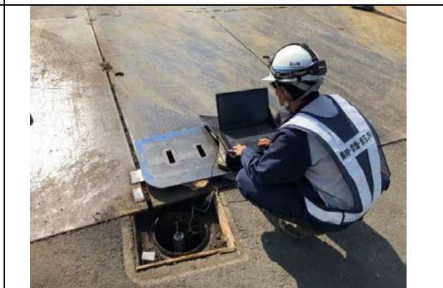
写真4-1-6-6 地下水の継続的な監視 (常時計測のデータ監視の様子)
