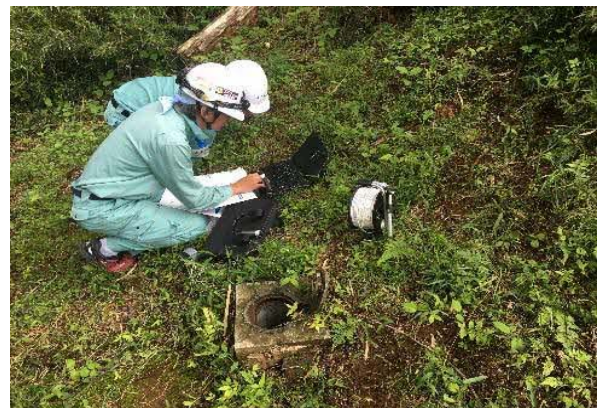
写真 4-1-11-6 地下水の継続的な監視
