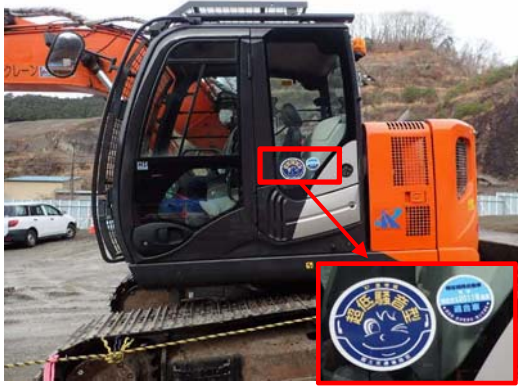
写真 4-1-11-1 排出ガス対策型建設機械の採用 低騒音型建設機械の採用
