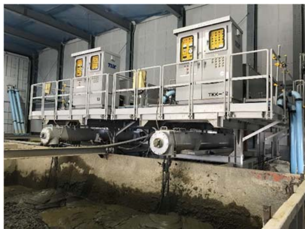
写真 4-1-4-10 建設汚泥の脱水処理 (遠心分離機による汚水と汚泥の分離状況)
