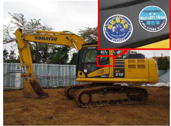
写真 4-1-5-2 排出ガス対策型建設機械の採用
