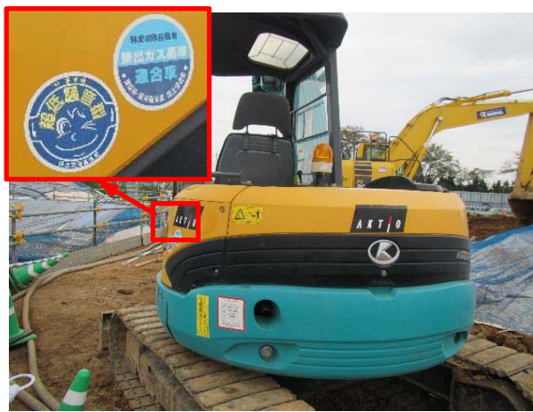
写真 4-1-5-3 低騒音型建設機械の採用
