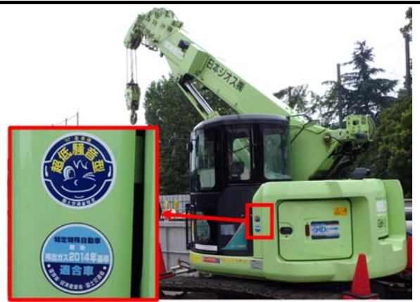
写真 4-1-1-2 排出ガス対策型建設機械の採用 低騒音型建設機械の採用
