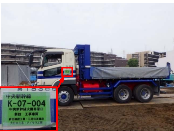
写真 4-1-3-16 工事に使用する道路、搬入時間の及び法定制限速度の遵守 (車両標識明示による安全運転意識の向上)
