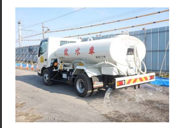
写真 4-1-2-4 工事現場の清掃及び散水
