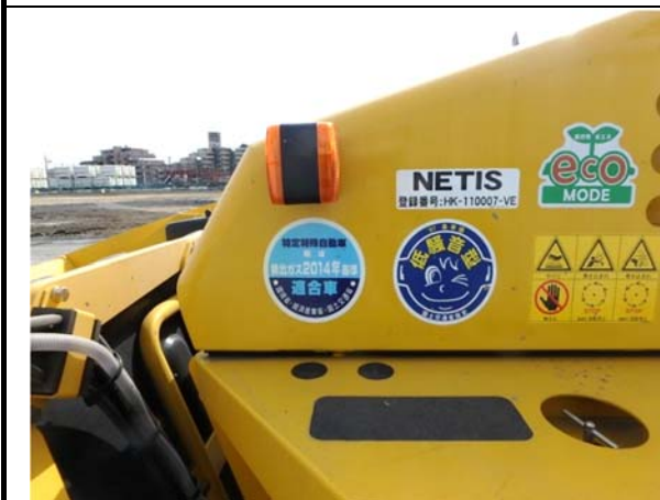
写真 4-1-2-2 排出ガス対策型建設機械の採用 低騒音型・低振動型建設機械の採用
