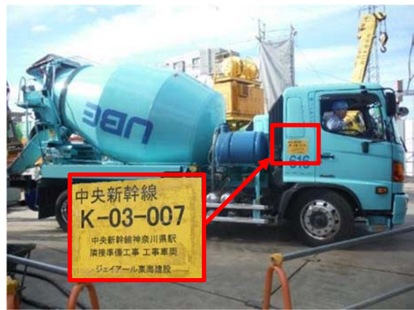
写真 4-1-3-9 工事に使用する道路、 搬入時間及び法定制限速度の遵守 (車両標識明示による安全運転意識の向上)
