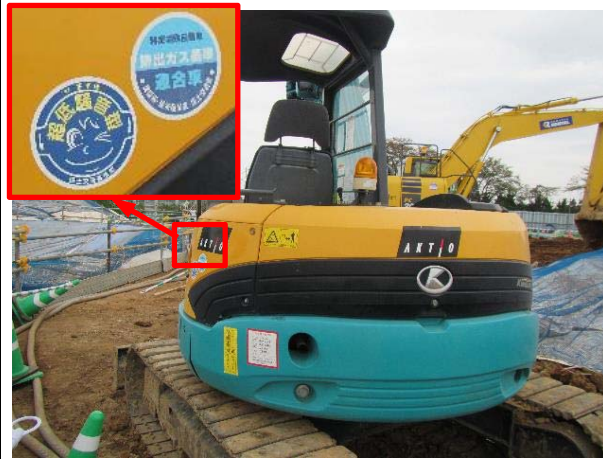
写真 4-1-2-3 低騒音型建設機械の採用
