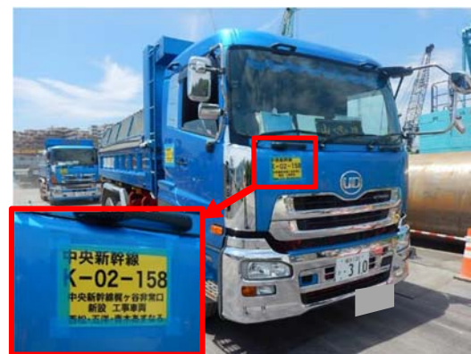
写真 4-1-1-15 工事に使用する道路、 搬入時間及び法定制限速度の遵守 (車両標識明示による安全運転意識の向上)
