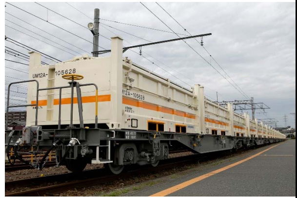
写真 4-1-1-11 貨物列車を活用した発生土の運搬
