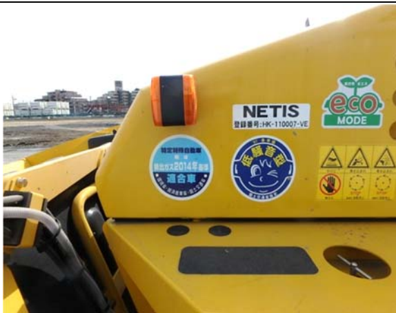
写真 4-1-1-2(1) 排出ガス対策型建設機械の採用 低騒音型建設機械の採用
