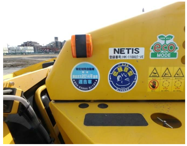
写真 3-1-1-2 排出ガス対策型建設機械の採用 低騒音型建設機械の採用
