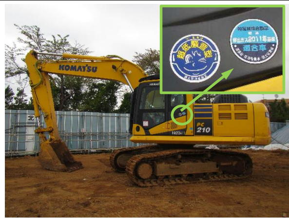
写真 3-1-2-2 排出ガス対策型建設機械の採用
