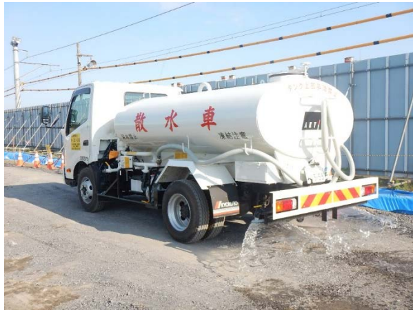
写真 3-1-1-3 工事現場の清掃及び散水
