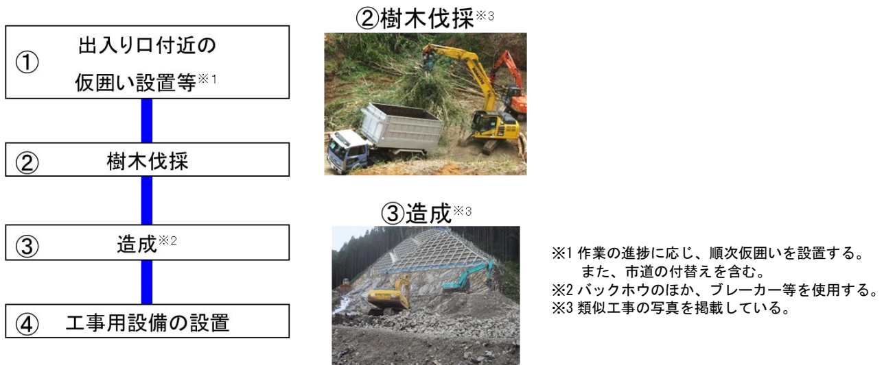
図 2-4 工事施工ヤード造成等の施工手順
