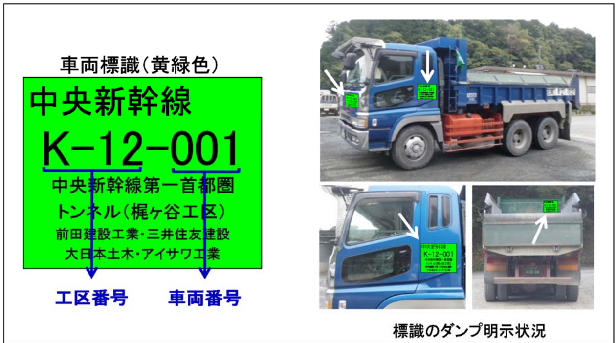
図 3-4 工事用車両標識の明示
