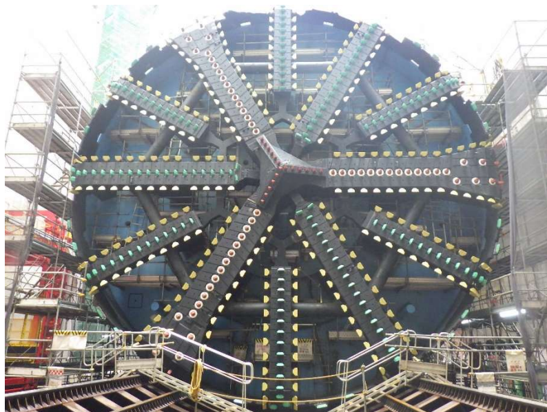
図 2-10 本工事に使用するシールド機（1号機）
