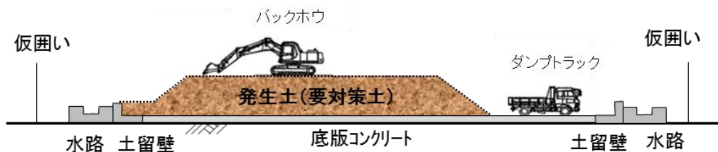
図 2-3-3(5) 山口下島地区発生土仮置き場における主な施工手順（発生土搬出）
