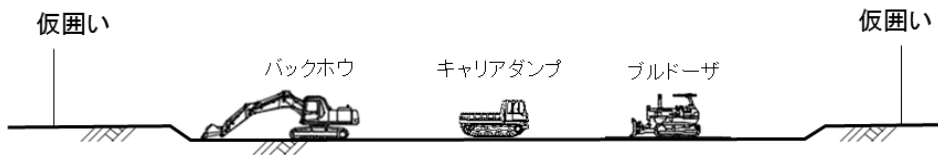
図 2-3-3(1) 山口下島地区発生土仮置き場における主な施工手順（耕土すき取り）
