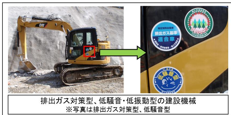
図3-4-1-1 工事用進入路新設における大気環境に関する計画面の環境保全措置 (写真は類似工事の例)
