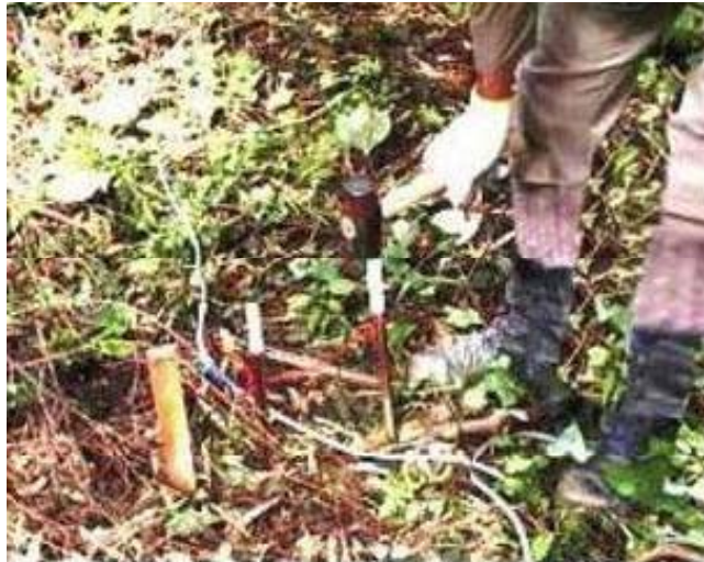
物理探査(電気探査)
