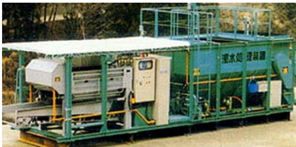
濁水処理装置の設置の例 「株式会社榑崎製作所HP」より
