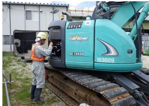
写真 4-1-3-4 建設機械の点検及び整備による 性能維持
