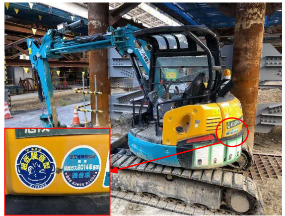
写真 4-1-8-2 排出ガス対策型建設機械の採用
