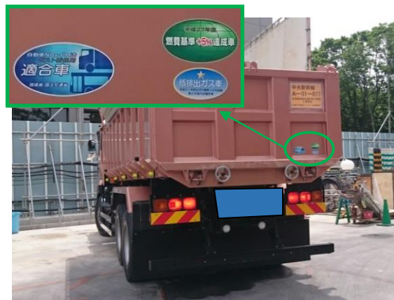
写真 4-1-6-9 低燃費車種の選定、積載の効率化、 運搬計画の合理化による運搬距離 の最適化最適化
