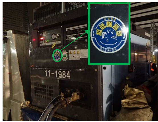
写真4-1-7-4 低騒音型建設機械の採用
