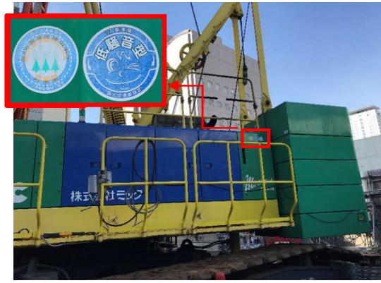
写真4-1-6-2 排出ガス対策型建設機械の採用 低騒音型建設機械の採用
