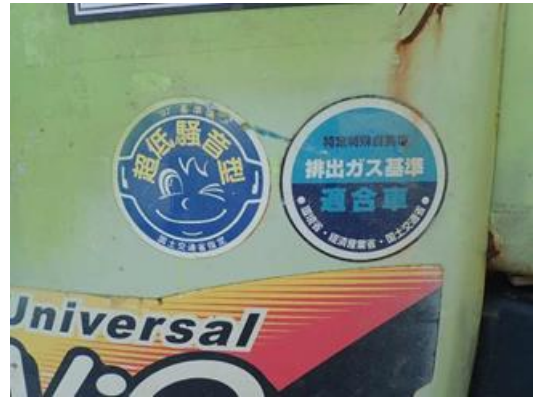
写真4-1-4-2 排出ガス対策型建設機械の採用 低騒音型建設機械の採用
