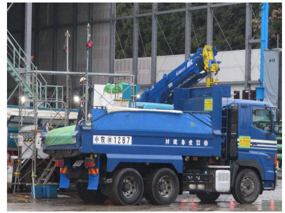
写真4-1-2-6 荷台への防じんシートの敷設
