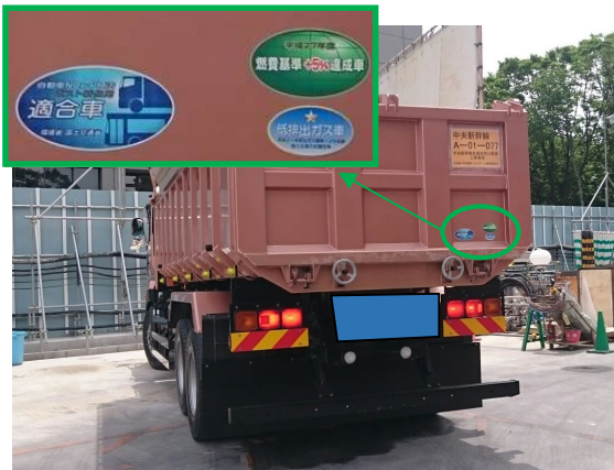
写真4-1-5-9 低燃費車種の選定、積載の効率化、 運搬計画の合理化による運搬距離の 最適化
