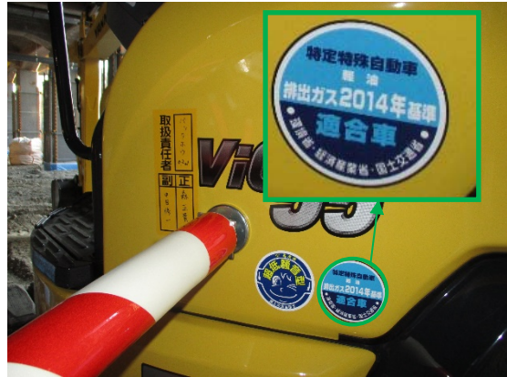
写真4-1-8-2 排出ガス対策型建設機械の採用
