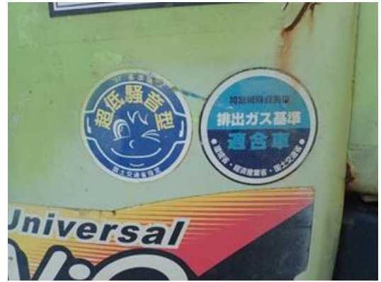
写真4-1-5-2 排出ガス対策型建設機械の採用 低騒音型建設機械の採用
