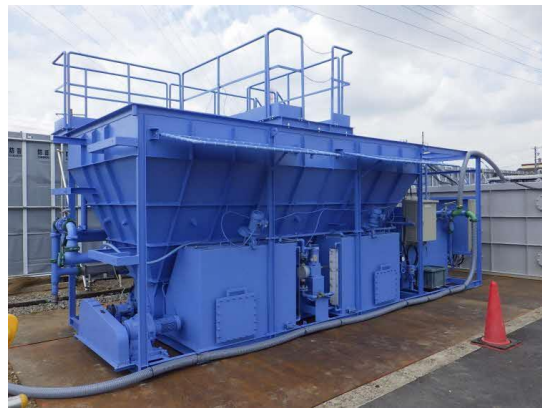
写真4-1-3-8 工事排水の適切な処理
