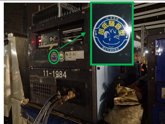
写真4-1-7-4 低騒音型建設機械の採用
