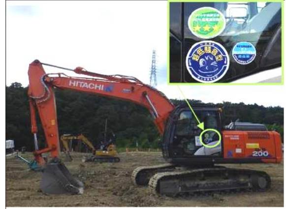
写真4-1-1-2 排出ガス対策型建設機械の採用 低騒音型建設機械の採用
