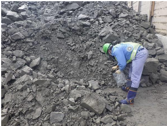
写真4-1-1-9 発生土に含まれる重金属等の定期的な調査
