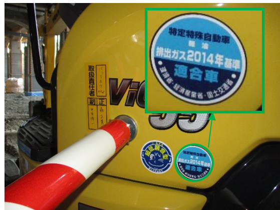
写真3-1-4-2 排出ガス対策型建設機械の採用
